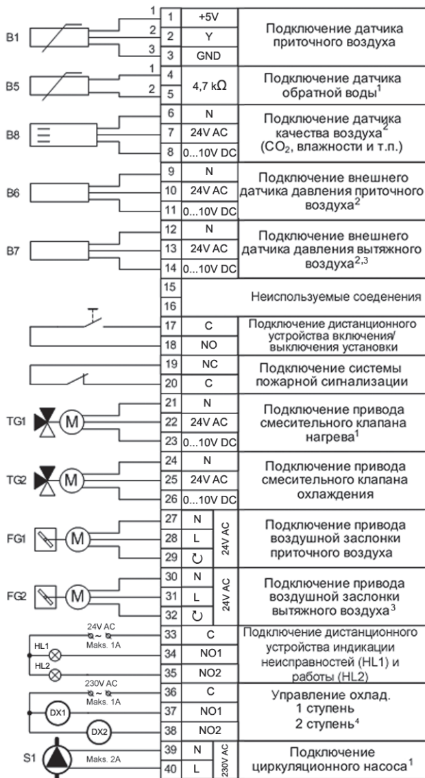
Р3 Схема внешних подключений элементов автоматики
