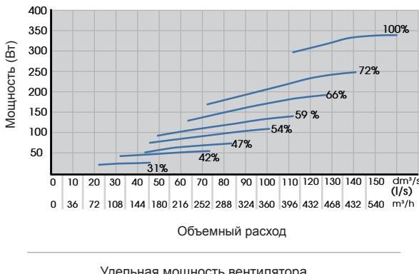
$$УМВ = \frac{\text{Входная мощность (общая Вт)}}{\text{Воздушный поток, указанный в вентиляционном плане (вытяжной л/с)}}$$
