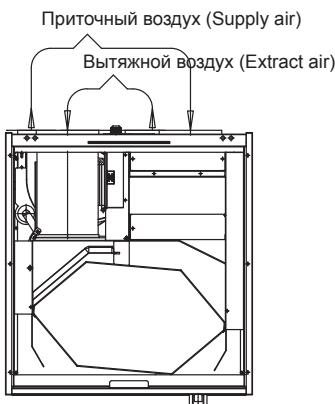
Точки измерения после выхода из соединения. Кривые вентилятора показывают общее давление, учтенное на потери в канале.
